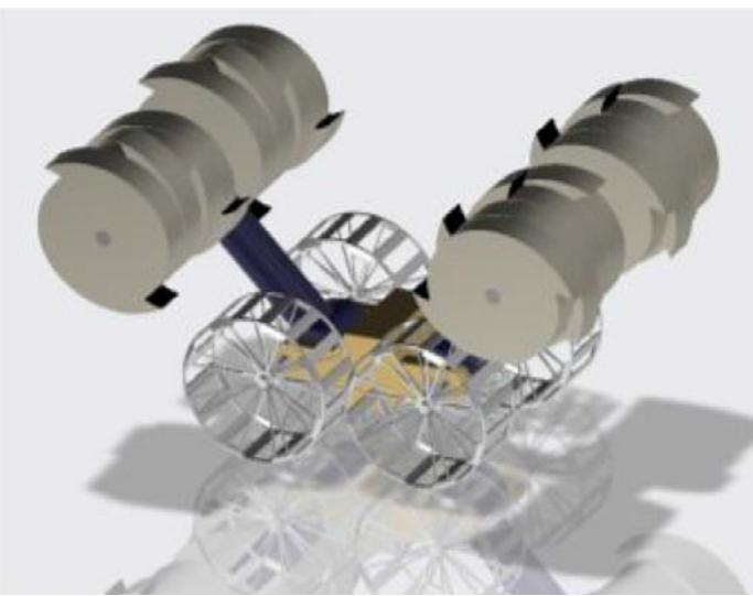
Fig. 2 Système d'extraction RASSOR de la NASA, réf [8]
