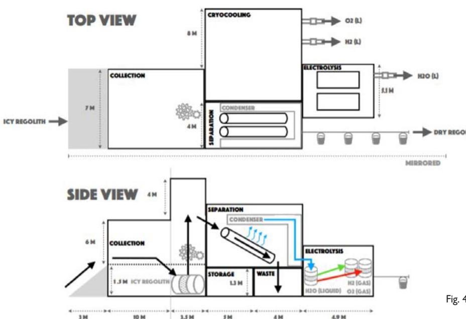
Fig. 4 Schéma de principe de l'usine de propogol, réf. [8]
